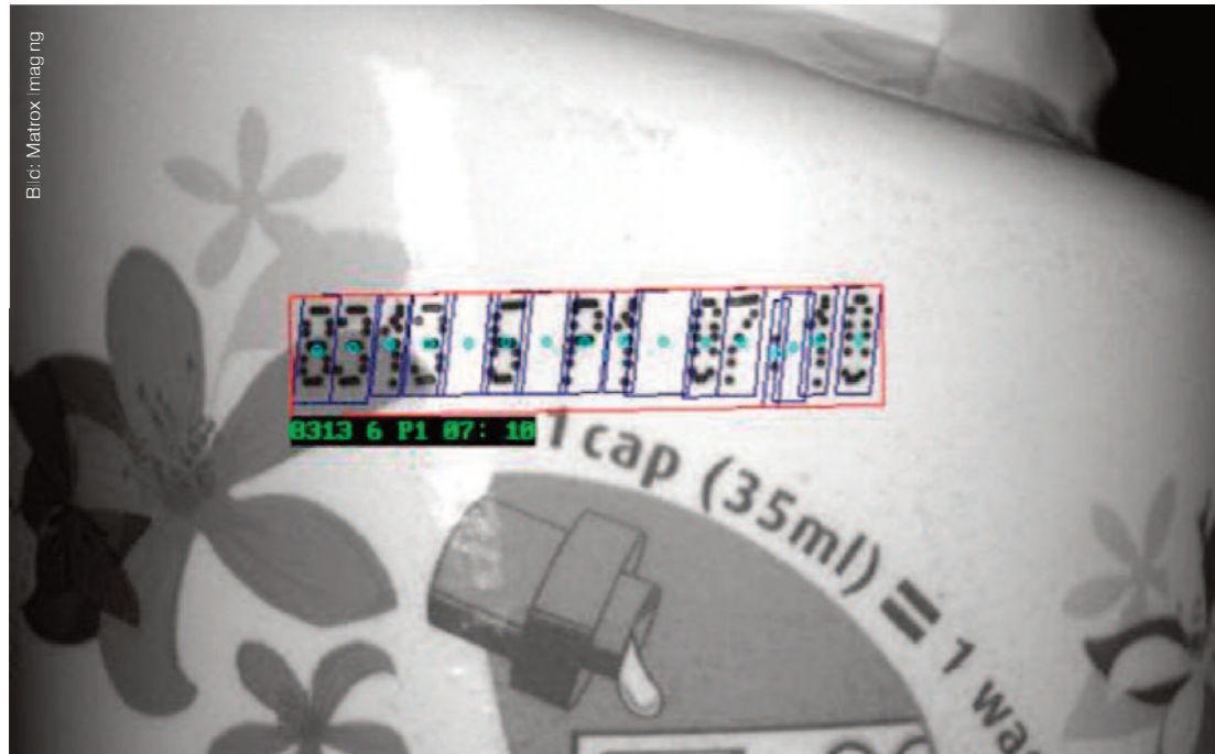
Bild 1 | SureDotOCR liest Punkt-Matrix Text auf unebenem Hintergrund. Im Unterschied zu klassischen OCR-Tools zum Lesen durchgängiger Zeichen umgeht es die Notwendigkeit von Vorverarbeitungsschritten.
