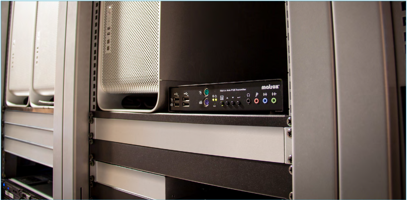
Avio F125發射器安裝在總控室內，連接到旁邊的Apple® Mac Pro®工作站上。Apple® Mac Pro®工作站運行Avid® Pro Tools®軟體。
