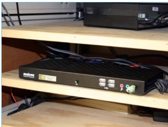
Extio F1400 supporta quattro monitor e workstation USB presso il centro operativo.
