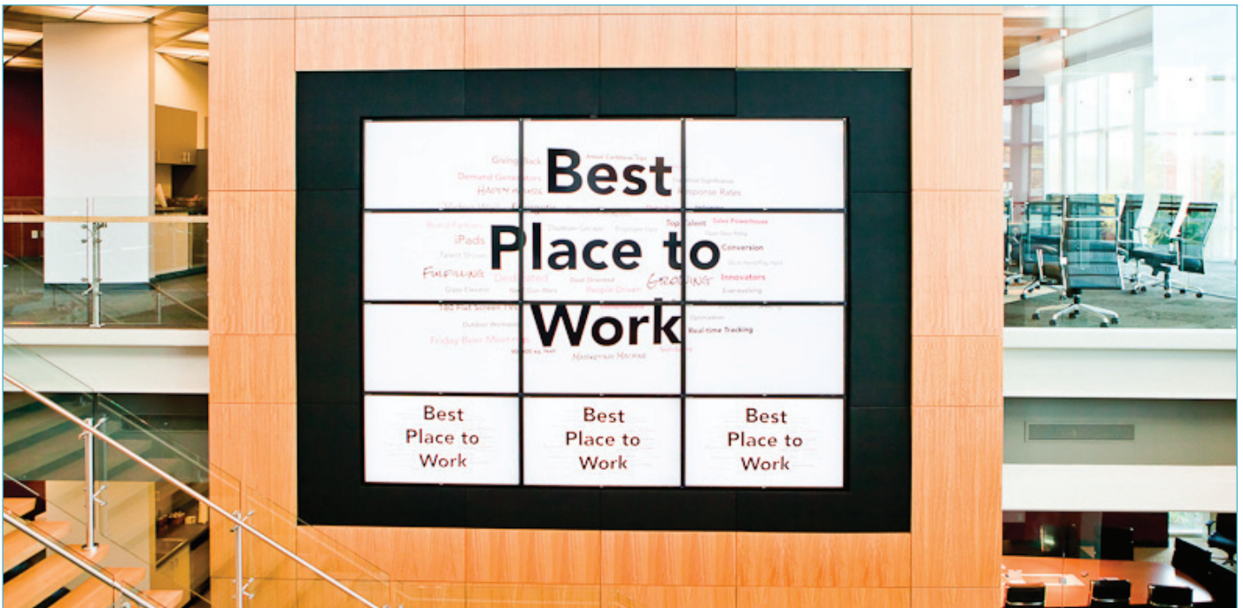
YCD MuVi Wall包含了三塊M9140顯示卡·驅動12臺顯示器·由一臺工作站控制·可以安裝成任何解板度·矩陣組合和任何角度·
